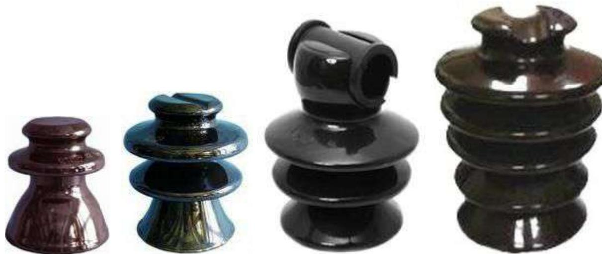
Изоляторы типа **ШФ-10, ШФ-20, ШФ-35** устанавливаются на стандартном штыре. Для их крепления используются колпачки серии К: **К-6, К-9, КП-22**. Провод может быть закреплен в желобе или на шейке изолятора. Крепление неизолированного провода к шейке изолятора ШФ осуществляется с помощью проволочной вязки **ВШ-1** и спиральной вязки серии **ПВС**. Для крепления изолированного провода СИП-3 используются спиральные вязки серии **ВС** или **СО**.
