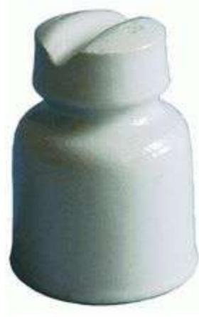
Предназначены они для изоляции и крепления неизолированных проводов на воздушных линиях электропередач (ЛЭП), в распределительных устройствах (РУ) электростанций и подстанций переменного тока напряжением до **1000 В**, линий связи и радиотрансляционных сетей. Устанавливаются на стандартных крюках **КН-12, КН-16, КН-18** или низковольтных траверсах через колпачки **КП-12, КП-16, КП-18** соответственно.
